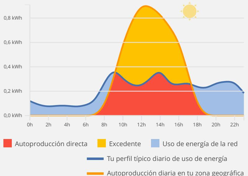
Calculado a partir de tus curvas horarias de uso de energía del **último año**, suponiendo un tejado con **orientación sur, 17° de inclinación y sin sombras**. La ingeniería encargada de la instalación ajustará la propuesta a tus condiciones según orientación y características del tejado, sombras, etc.
